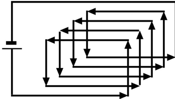
上図のように磁石で巻数を増やすと、強い磁石ができる。電磁方程式に  $\text{rot}H = \partial D / \partial t + i$  がある。直流の場合には  $\partial D / \partial t = 0$  であるから、 $\text{rot}H = i$  となる。磁石の鉄心への巻数を  $n$  とすれば、 $\text{rot}H = ni$  となり磁界の強度は  $\text{rot}H$  は  $n$  倍となる、と思ったのだがよいのだろうか。
